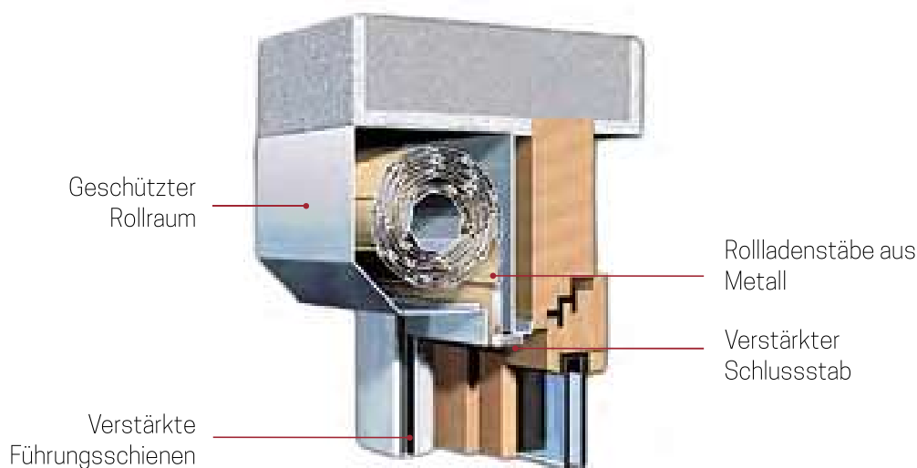
➤ Querschnitt eines Rollladens nach DIN EN 1627
